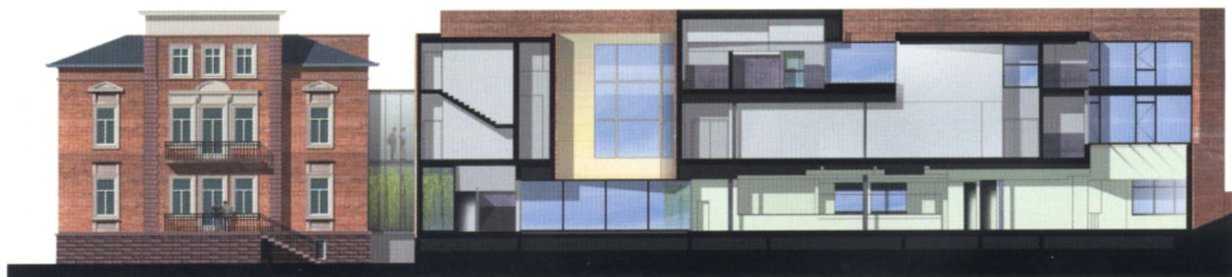
Coupe longitudinale sur le bâtiment au niveau de sa liaison vitrée avec la villa restructurée.
