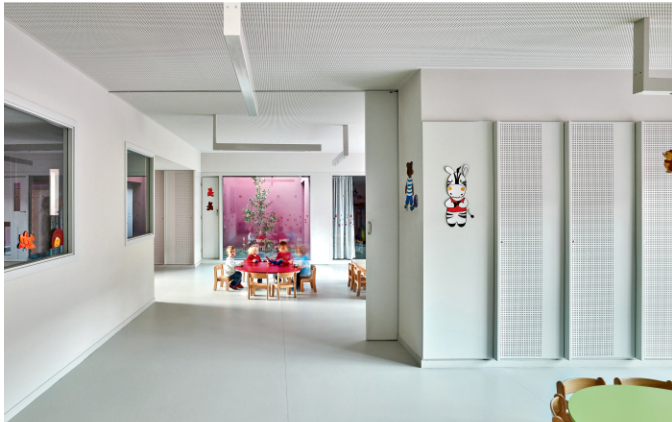
Mittels einer Schiebetür lässt sich der Gruppenraum der Kleinkinder von dem der Vorschulkinder abtrennen. • The group room of infants can be separated from the preschool children's room by means of a sliding door.
