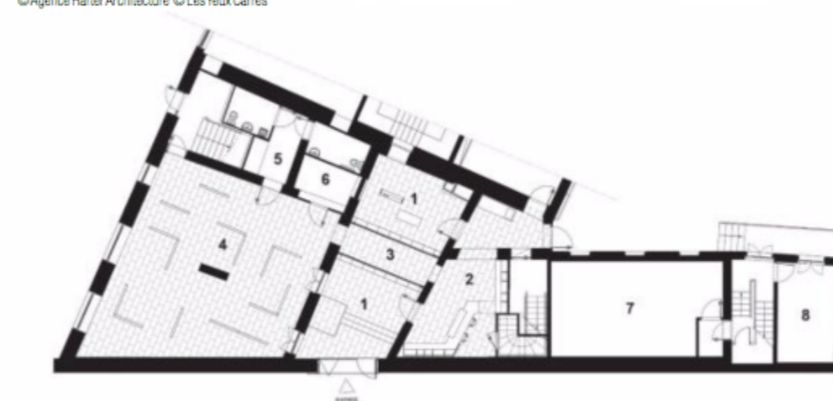
10m — Plan RDC ©Agence Harter Architecture 1 patio - 2 accueil et espace vente - 3 galerie - 4 salle d'exposition - 5 sanitaires - 6 back office - 7 archives et fond - 8 bureau
